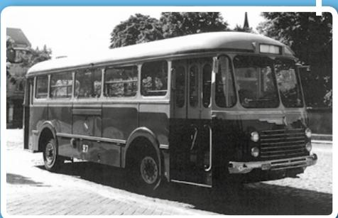
Nouvelle génération à portes pneumatiques à l'avant et à l'arrière pour sortir.
