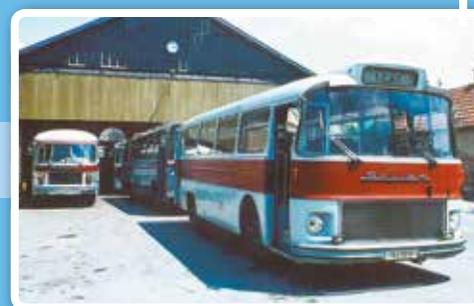
La TCAT acquiert des Saviem à 3 portes à plancher plat. Ils ont fonctionné près de 30 ans. En 1975, ils deviennent orange et blanc et le tissu remplace le bois des sièges.
